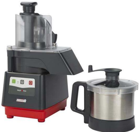
déverrouillage sans tension empêche le démarrage accidentel de l'appareil. Toutes les pièces en contact avec les aliments sont amovibles et passent au lave-vaisselle. Boutons étanches, faciles à nettoyer, plats. Vitesse unique de 1800 tr/min avec fonction marche/pulse/arrêt pour des opérations simples. Avec prise NEMA 5-15P.
